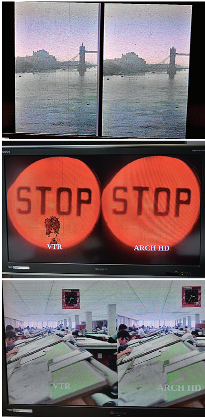
Archangel Ph.C-HDによる画質補正前後を比較する映像（上からスクラッチ除去、ゴミ除去、ジャギー補正）
